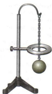
Расширение тел при нагревании
