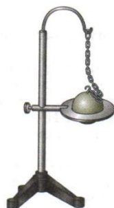
Расширение тел при нагревании
